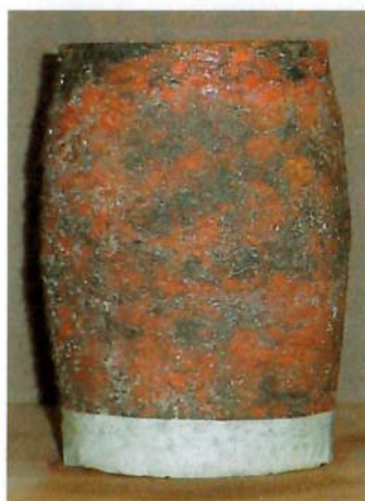
Figura 05 - Amostra de sal deformada após sofrer um diferencial de tensões (MAIA, 2005b).
